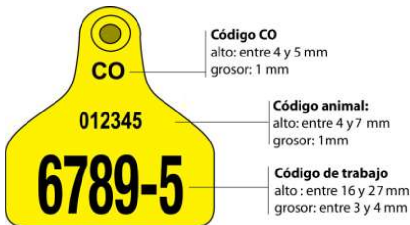
Gráfica 21. Imagen de la pieza macho tipo paleta de la orejera tipo paleta sin RFID.
