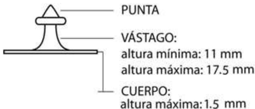
Gráfica 9. Dimensiones de la pieza macho de la orejera tipo botón con RFID.
